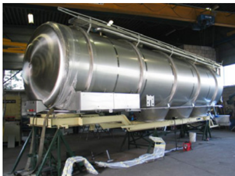
Les citernes en inox de Hazeleger, dont le soudage est automatisé via les machines de cordons de soudure longitudinaux et circulaires d'ADK Techniek.
